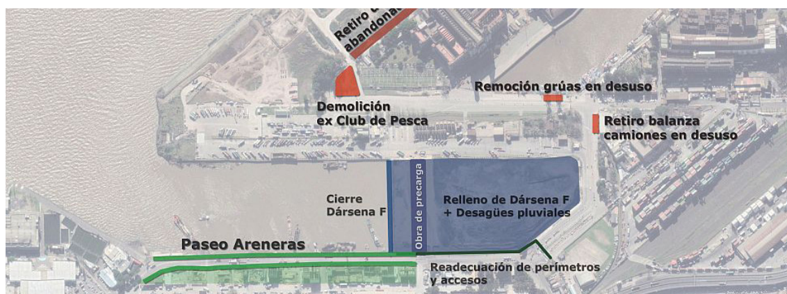
Ouvrages de contention, remblaiement, élimination des obstacles et aménagement de promenades (réalisés ou en cours de réalisation)
